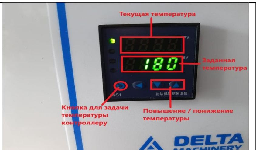
Когда нагрев достигнет установленной температуры, нажмите на выключатель двигателя, чтобы начать работу. (Рекомендуется прогреть станок в течение 15-20 минут для того, чтобы весь термоклей расплавился перед началом фиксации краёв до запуска двигателя.)
